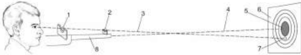
Іл. 25.5 Схема прицілювання в разі перевищення середньої точки прицілювання: 1 — середина прорізу прицілу; 2 — верхній край мушки; 3 — лінія прицілювання; 4 — середня траєкторія кулі; 5 — середня точка влучення — центр мішені; 6 — мішень; 7 — точка прицілювання; 8 — ствол гвинтівки
