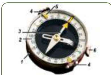
Іл. 27.1. Компас Адріанова: 1 — корпус; 2 — шкала (лімб); 3 — магнітна стрілка; 4 — візирний пристрій (мушка і цілик); 5 — показчик відліків; 6 — гальмо
